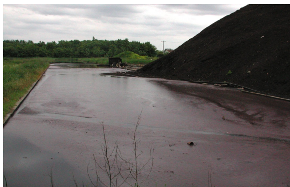
Stockage de marcs en plein air en attente de traitement et « jus de piles » (lixiviats), dans diverses distilleries
